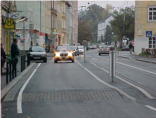
Graz – Leonhardtstrasse plateau surélevé au niveau d'un arrêt tram/bus sur une voie principale
