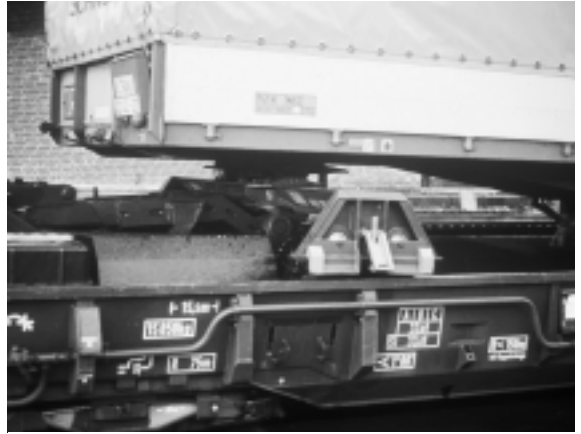
Le wagon de 1981 - 1988 qui succéda au wagon Wippen destiné au transbordement de semi-remorques non préhensibles par pinces - sur la photo la poutre d'appui
