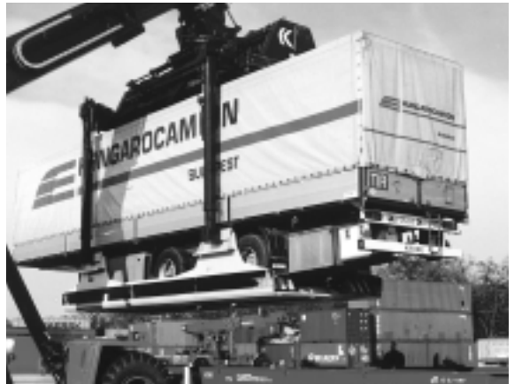
Un wagon panier hongrois du milieu des années 90 permettant le transbordement vertical de semi-remorques non préhensibles par pinces
