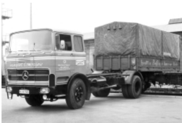
Chargement horizontal d'une caisse mobile. Une technique testée en Allemagne qui a dû faire place au transbordement vertical en 1970
