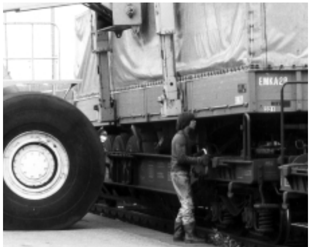
Le positionnement de la sellette mobile sur le terminal de Cologne A gauche : la roue avant du "Piggy Packer "
