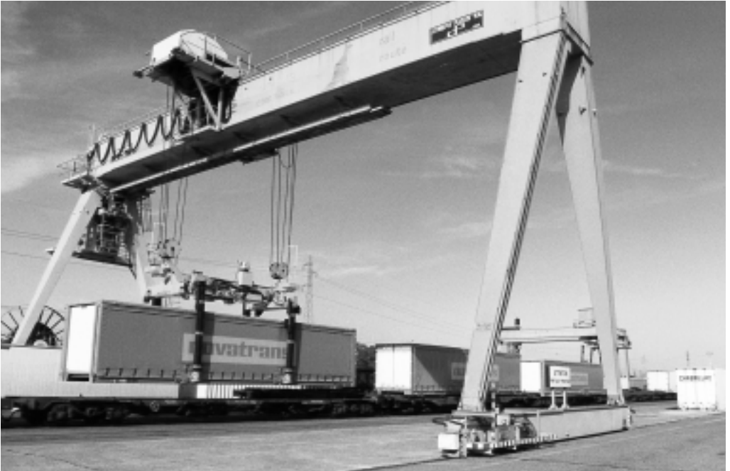
Transbordement d'une caisse mobile chez Novatrans, en France
