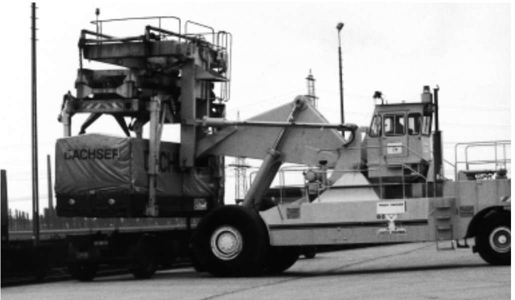
La première grue mobile, le "Piggy Packer" fut mise en service par Kombiverkehr en 1973 sur le chantier de Neuss
