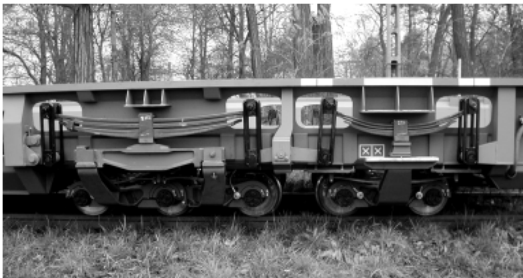
Le bogie à cinq essieux du wagon de Route Roulante chez Ökombi en service à partir de 2001
