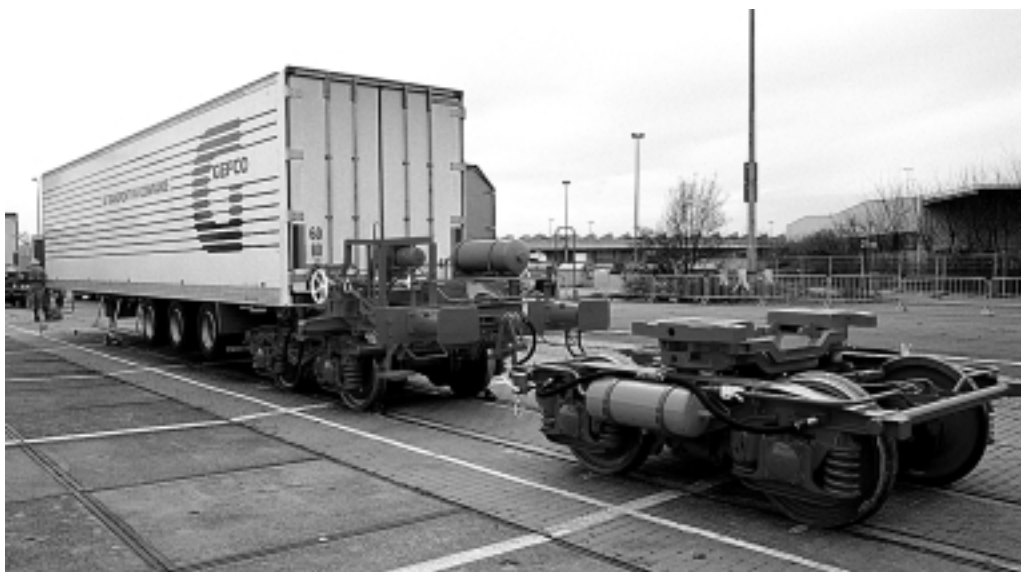
Un bogie bimodal et une semi-remorque chargée aux Etats-Unis; en service sur la ligne Cologne-Munich-Vérone depuis 1995
