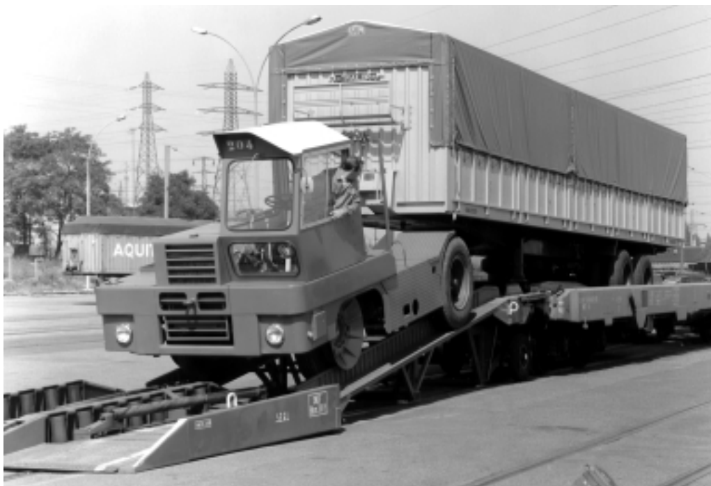
La technique kangourou utilisée par Novatrans et TRW entre 1959 et 1986
