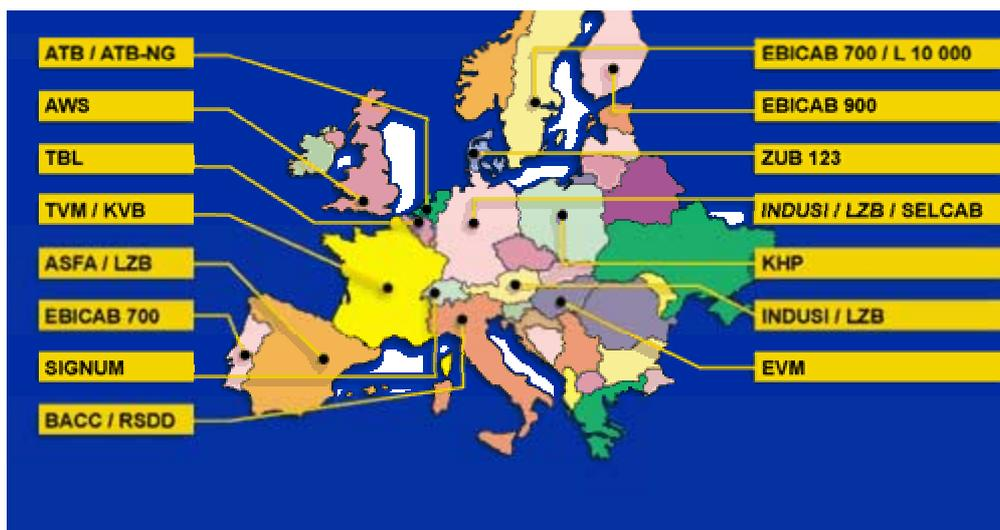
Systèmes de signalisation avec contrôle de vitesse existants en Europe (source : Alstom)
