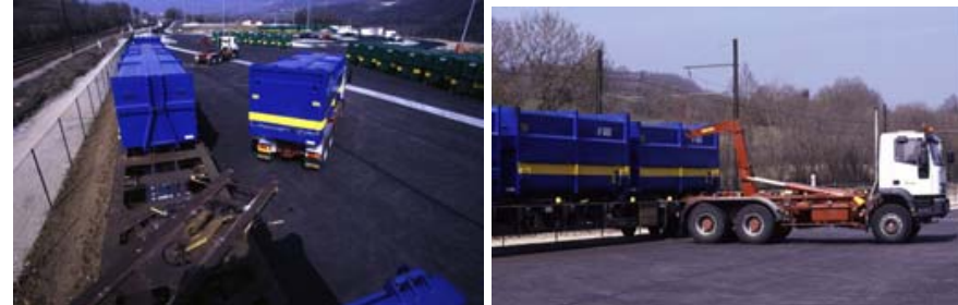
Mise en place d'une caisse mobile grâce au système Multiberces
