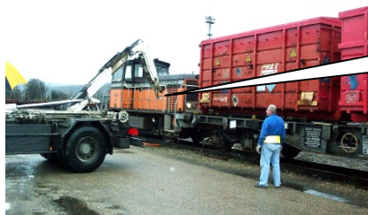
Pivotement de la caisse sur le wagon
