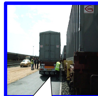
Positionnement du semi sur la plate-forme de transbordement
