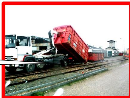
Crochetage de la caisse et transfert sur le camion
