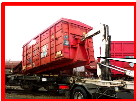
Pivotement de la caisse sur le wagon
