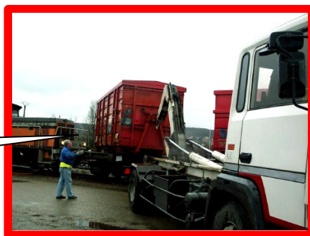
Crochetage de la caisse et transfert sur le camion
