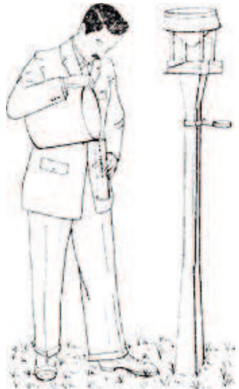
**Le pluviomètre dit « Association », qui a été diffusé par l'association scientifique de France, fondée par Le Verrier en 1864. Certains de ces pluviomètres sont encore utilisés dans le réseau climatologique de Météo-France.**
