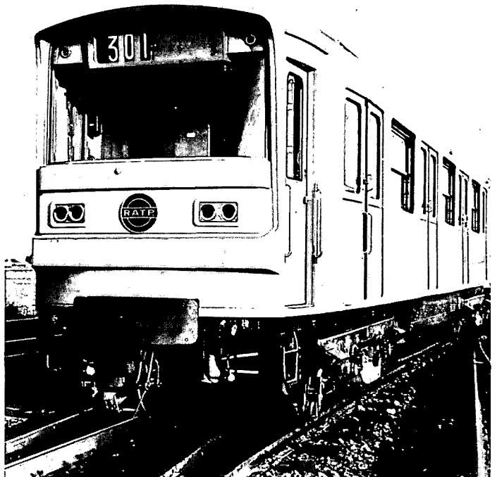
Équipement de la ligne N° 6 en matériel sur pneu (cliché Alsthom)
