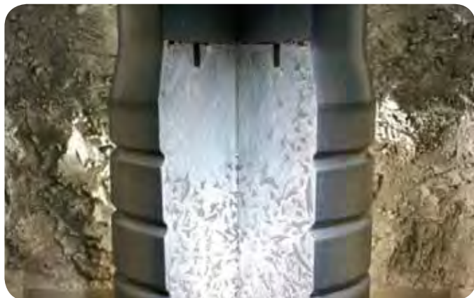
Fût découpé contenant des déchets liquides de moyenne activité solidifiés dans du béton. Il s'agit de matériaux fortement contaminés, comme des enveloppes de barres de combustible ou des parties démontées de la cuve du réacteur, qui nécessitent un blindage anti-rayonnement. Le temps de stockage dépend des isotopes radioactifs présents. Les liquides radioactifs sont solidifiés avant leur élimination. Photo : Dounreay
