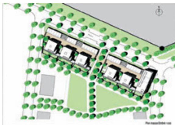
Figure 5 / Opération de Caen : L'implantation de l'opération de Caen est face à la prison, et à côté d'une station essence. Cet environnement a dicté le plan masse : les garages servent de tampon entre les immeubles villas et la prison ; un petit collectif vert isole la parcelle de la station essence.
