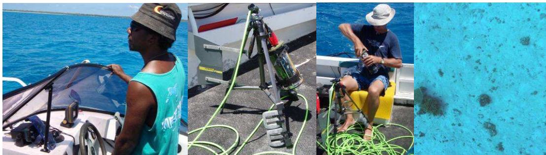
Figure 1. Le système vidéo sous-marin peut être manipulé à bord d'une petite embarcation, suivant un cap déterminé et une vitesse faible le long de transects. La profondeur de la caméra est ajustée manuellement, grâce à un écran de contrôle. Elle fournit des images haute résolution, dont la qualité dépend cependant des conditions de mer (visibilité, houle). Sur Ouvéa, 22 km de transect ont été filmés : près de 2000 images ont été extraites puis traitées semi-automatiquement pour cartographier les dégradations observables sur les récifs coralliens.
