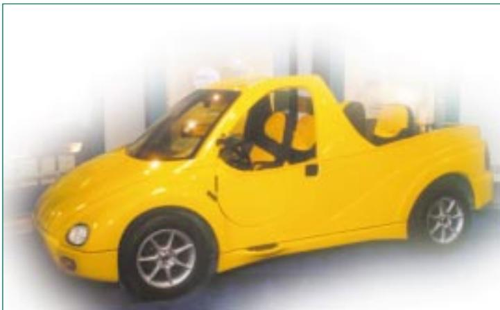
La Baja de AD&C est un SUV à châssis de fibre de verre et ester de vinyle.
