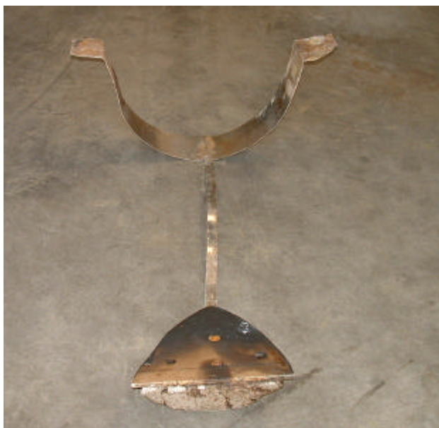
Figure 8 : Seuil de hauteur avec le feuillard et la tôle de fixation.
