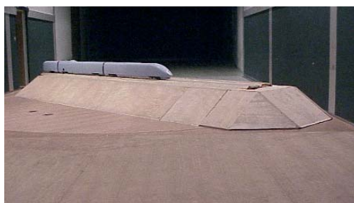
Essai en soufflerie DNW de la maquette au 1/7 ème du TGV Duplex.
