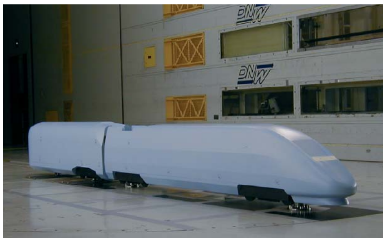
Essai en soufflerie DNW de la maquette au 1/7 ème du TGV Duplex.
