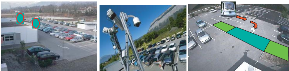
Figure 2 : Site expérimental de l'Inria/Rhône-Alpes pour le scénario "Passage de piéton en carrefour". Un jeu de caméras est implanté dans l'infrastructure, chacune équipée d'un dispositif de suivi de cibles mobiles. La zone verte représente le passage piétons.
