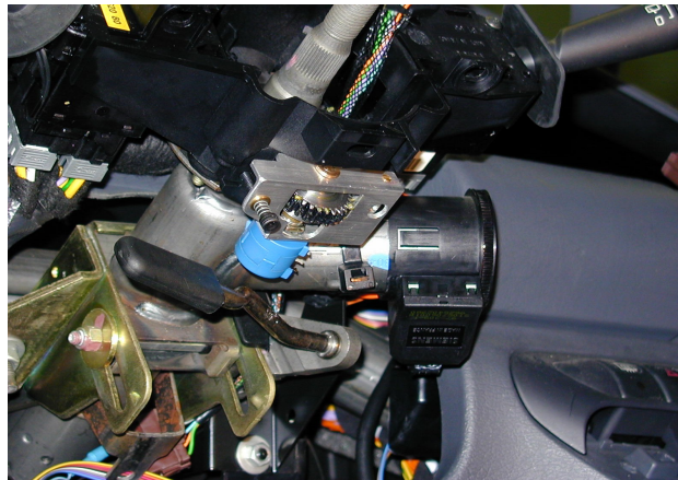
Figure 5 - Montage mécanique du capteur d'angle au volant du véhicule VELAC
