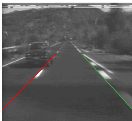
Figure 1 - Exemple de reconnaissance de la chaussée
