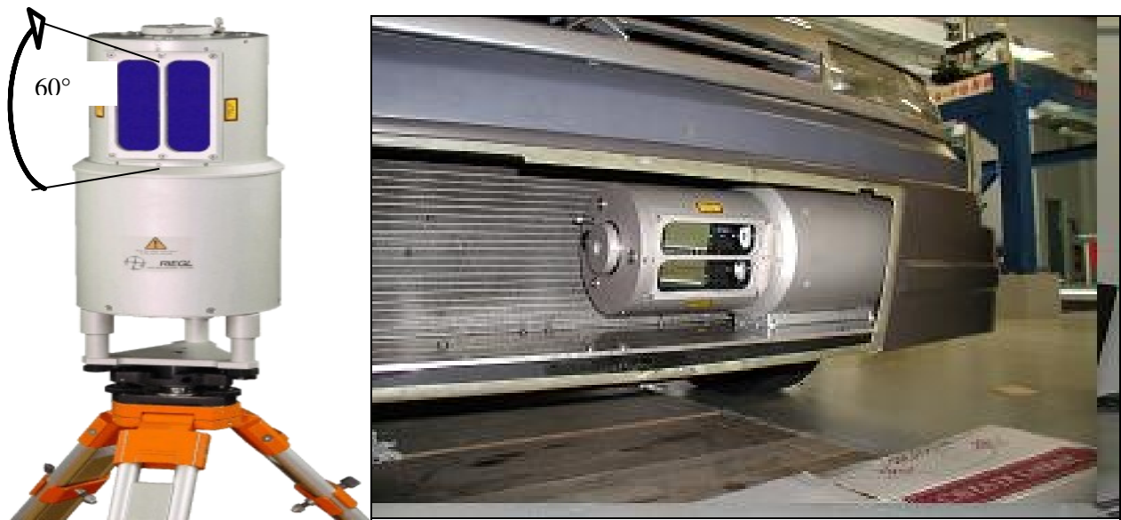
Figure 45 - 3D-Laser Mirror Scanner ' LMS-Z210-60' dans le pare-chocs de VELAC.
