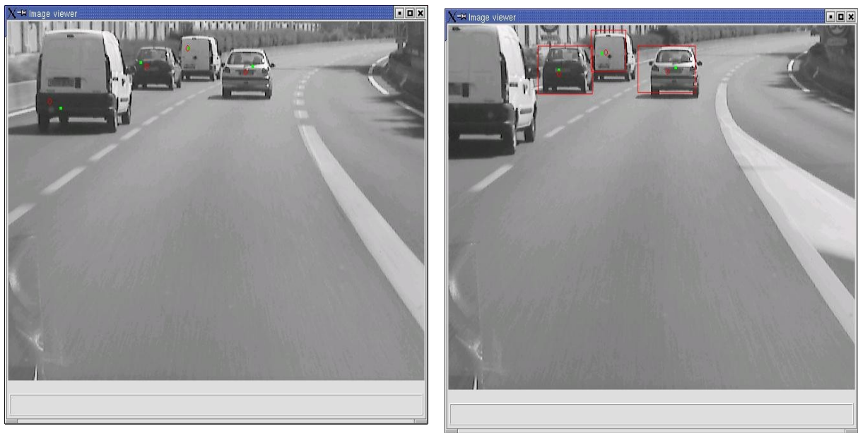
Figure 54 - Suivi d'obstacles multiples. Figure (a) montre les centres des obstacles suivis et (b) montre le rectangle englobant chacun des obstacles.
