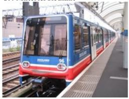
Les voitures ont un plancher surélevé et quatre portes de chaque côté. Il n'ay a pas de cabine de pilotage, mais une petite console verrouillée que le PSA peut activer si nécessaire. L'absence de conducteur permet aux passagers de jouir d'une vue dégagée tout au long du trajet.
