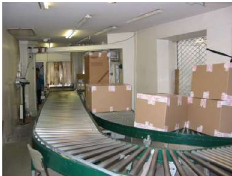
Chaîne de tri automatisée du bureau de ville des Transports Besson (crédit photo : projet PILU)
