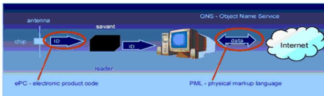
**Savant** est la technologie logicielle utilisée pour la gestion et le transfert des informations de manière telle à ne pas surcharger les réseaux professionnels et particuliers existants. Elle utilise une architecture distribuée, c'est-à-dire qu'elle peut fonctionner sur un seul ordinateur central ou sur plusieurs ordinateurs d'une même organisation. Savant constitue "le système nerveux" du réseau EPC car c'est lui qui gère le flux des informations.
