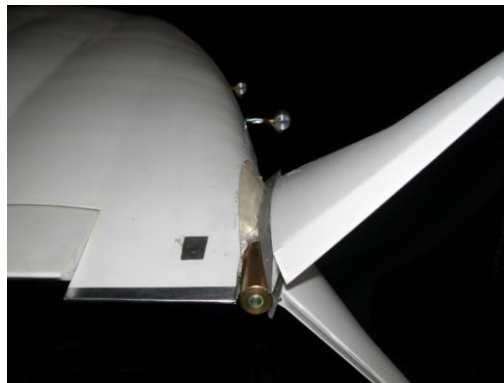
Fig. 8 : Version V3 : Ailette double flèche en position inclinée \varepsilon = 45^\circ . Gouvernes en roulis et en lacet braquées.
