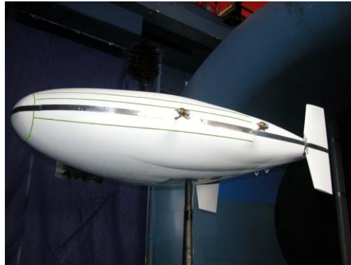
Fig. 4 : Version V2 symétrique – Ailettes en configuration verticale \varepsilon = 0^\circ
