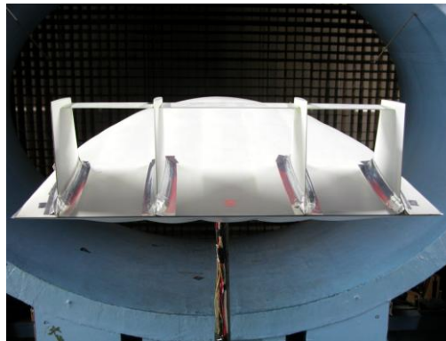
Fig.2 : La partie arrière dans sa version V0, avec ajout de Karmans
