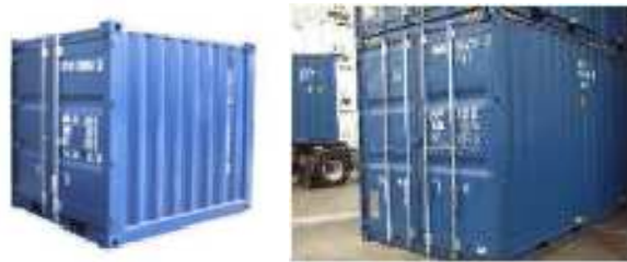
Figure 27 : illustration des conteneurs 7’ et 10’ HC
