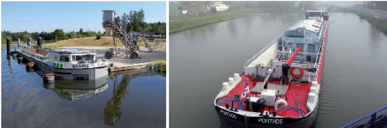
Figure 14 : exemples de bateaux au gabarit Freycinet
