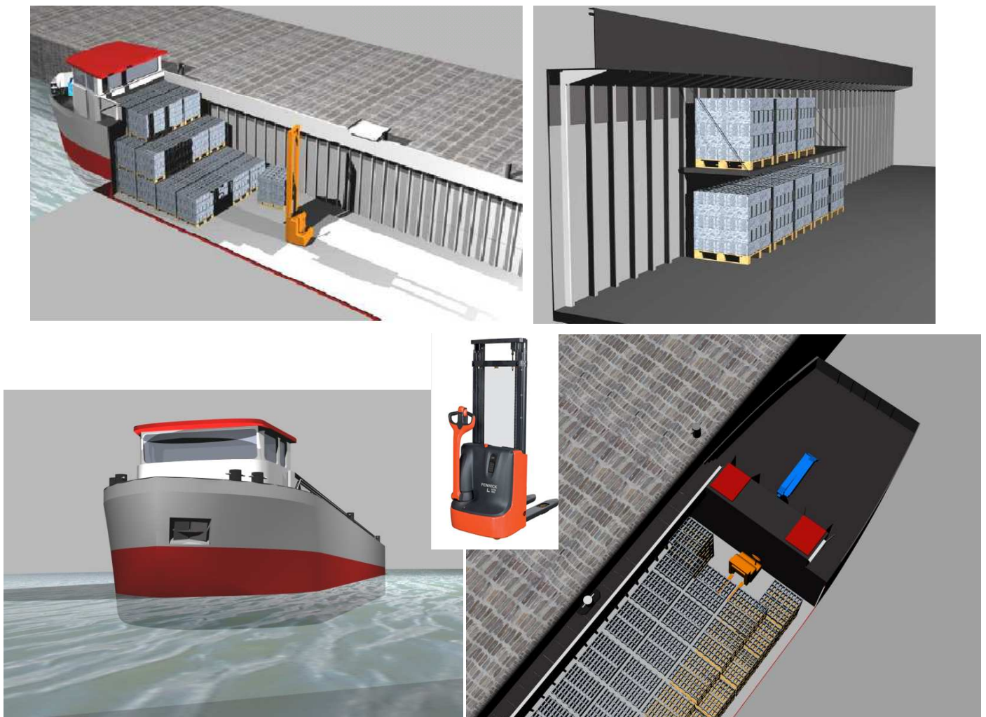
Figure 32 : vues 3D du porte-conteneurs 7' – 10' HC
