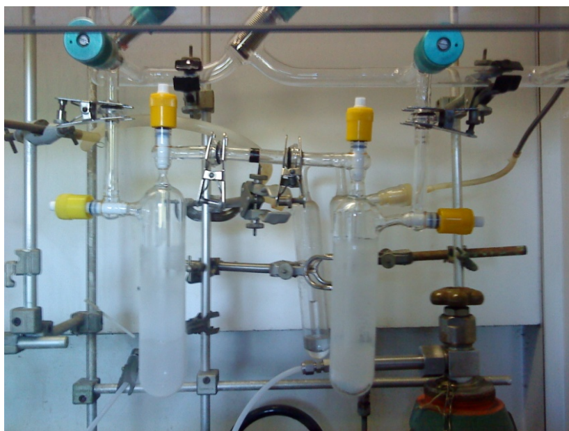
Figure 12 : Photographie du dispositif expérimental utilisé pour la synthèse des kétonitrates
