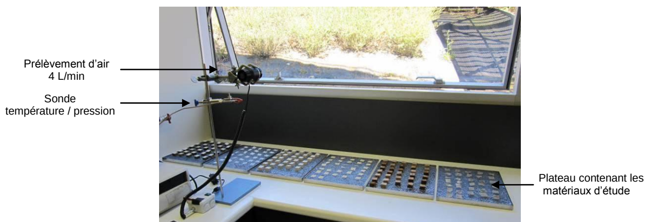
Photographie 3 : Dispositif expérimental dédié à la biocontamination des supports (de gauche à droite sont disposés les éprouvettes de : dalle acoustique, toile de verre, plaque de plâtre, bois et lin).
