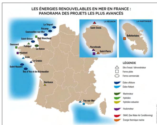
**Site d'essai / démonstrateur** : prototype ou machine dite « première de série » à l'échelle réelle, nécessaire à valider ou de modifier le design et/ou les procédés d'installation et d'intervention en mer. Ces tests sont réalisés pendant une période assez courte (quelques mois).
