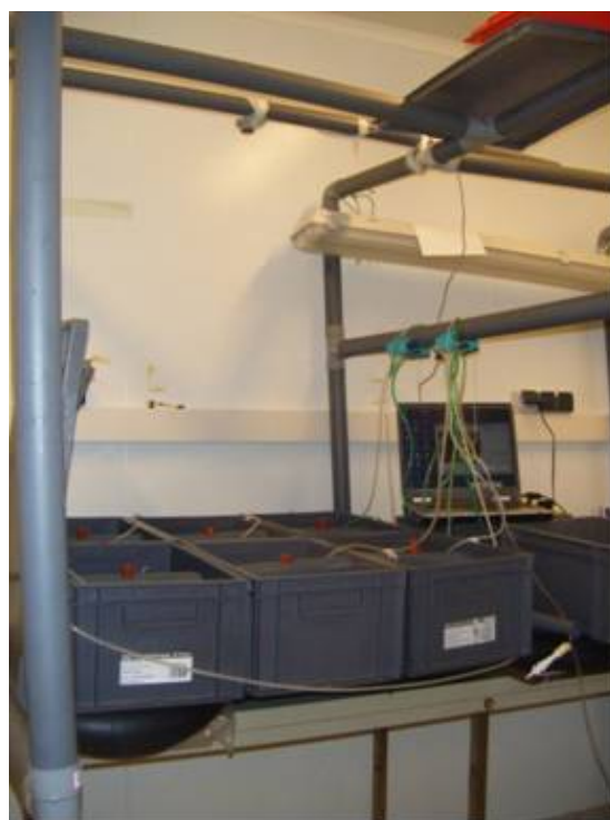
Figure 85 Dispositif expérimental pour les manipulations sur l'enfouissement comprenant les bacs disposés sur la paillasse, le circuit d'oxygénation et la caméra reliée à l'ordinateur.
