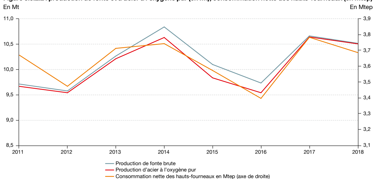
Figure 3.3.2.2 : production de fonte et d'acier à l'oxygène pur (en Mt), consommation nette des hauts-fourneaux (en Mtep)
