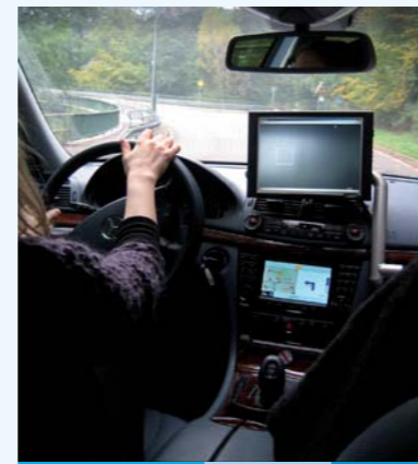
Prototype PSA SafeMAP embarqué avertissant visuellement le conducteur d'un virage dangereux 8 secondes avant d'arriver dans cette zone à risque.
