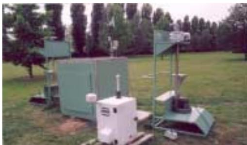
**Figure 15 :** *Dispositif de prélèvement d'air pour les mesures d'exposition*
