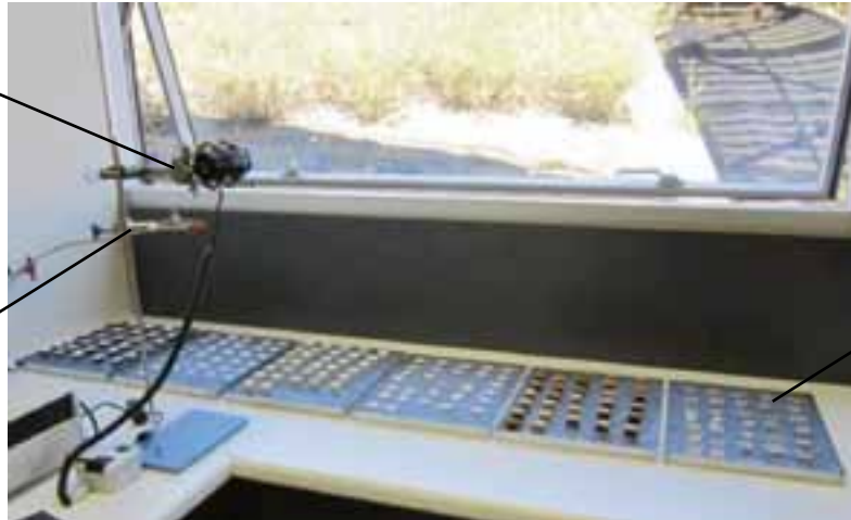
Figure 1 : Prélèvement en continu de la flore aéropartées au-dessus des supports testés.
