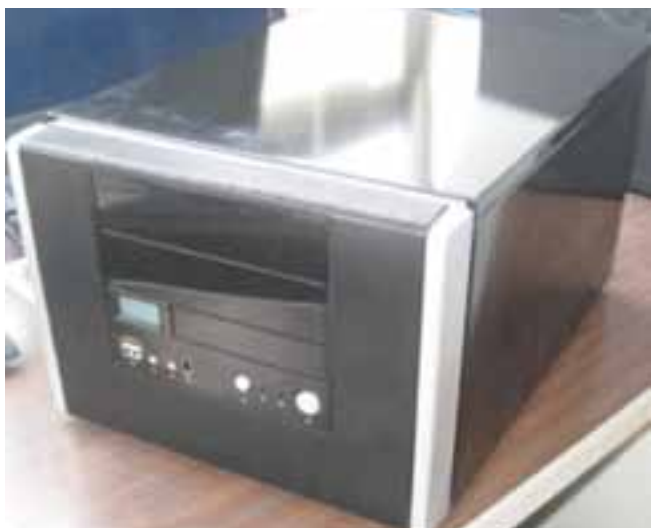
Figure 1 : Prototype de 2 e génération de l'analyseur. Le prototype est transportable (env. 8 kg) et a une dimension de 28,5 x 23 x 38 cm (soit environ la taille d'une imprimante).
