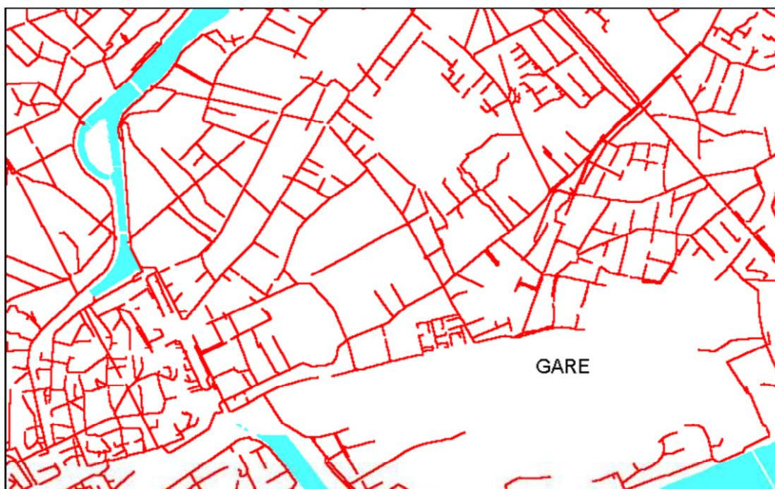
Figure 6. Extrait d'un plan de réseau d'assainissement urbain
