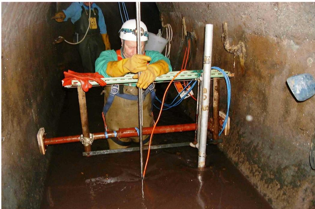
Figure 18. Mise en œuvre d'un courantomètre pour l'exploration du champ de vitesses dans un collecteur
