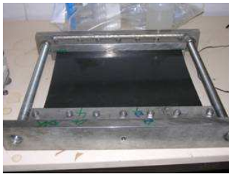
Figure 16: Géomembrane non soudée tendue dans son cadre de relaxation
