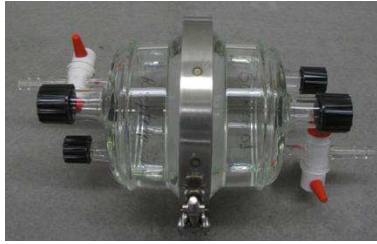
Figure 14: Cellule d'essai utilisée pour quantifier la diffusion des phénols dans les Films de PE.
