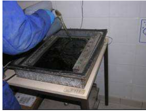
Figure 18 : Remplissage en lixiviat de la cellule d'immersion de l'échantillon E1 dans son cadre de relaxation.
