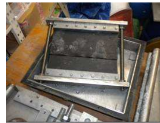
Figure 17: Géomembrane soudée tendue dans son cadre de relaxation
