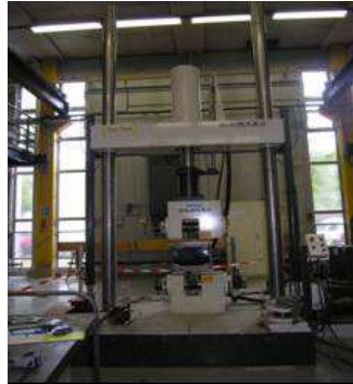
Figure 15 : cadre de relaxation placé dans la machine de traction
