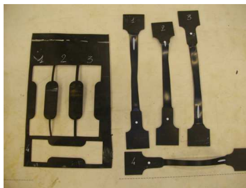
Figure 64 : éprouvettes découpées dans l'échantillon E ref après l'essai de traction
