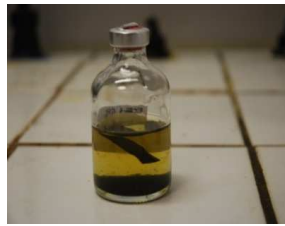
Figure 12: Film de PE (40 mm x 100 mm x 150 µm) incubé dans un flacon contenant un lixiviat.
