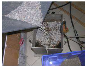
Figure 20 : mise en place des granulats sur l'échantillon Ep dans son cadre de relaxation
