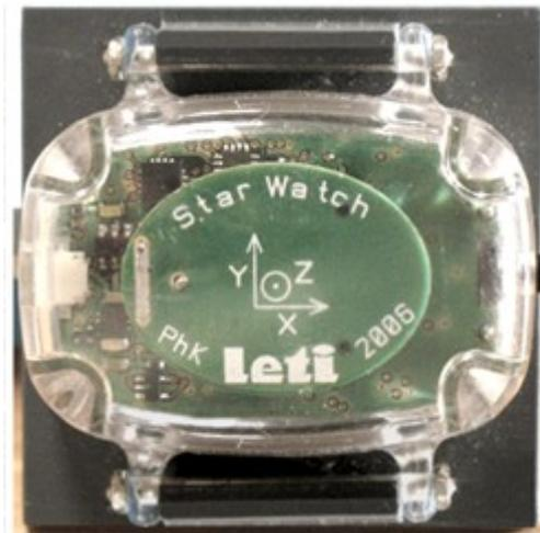
*Figure 26 : Photo d'un capteur Star Watch tri-axe*
