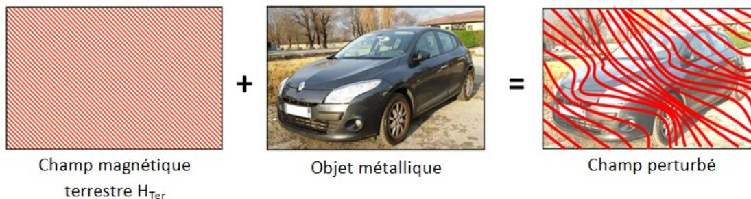
**Figure 10 : Perturbation du champ magnétique terrestre en présence d'un objet métallique**
