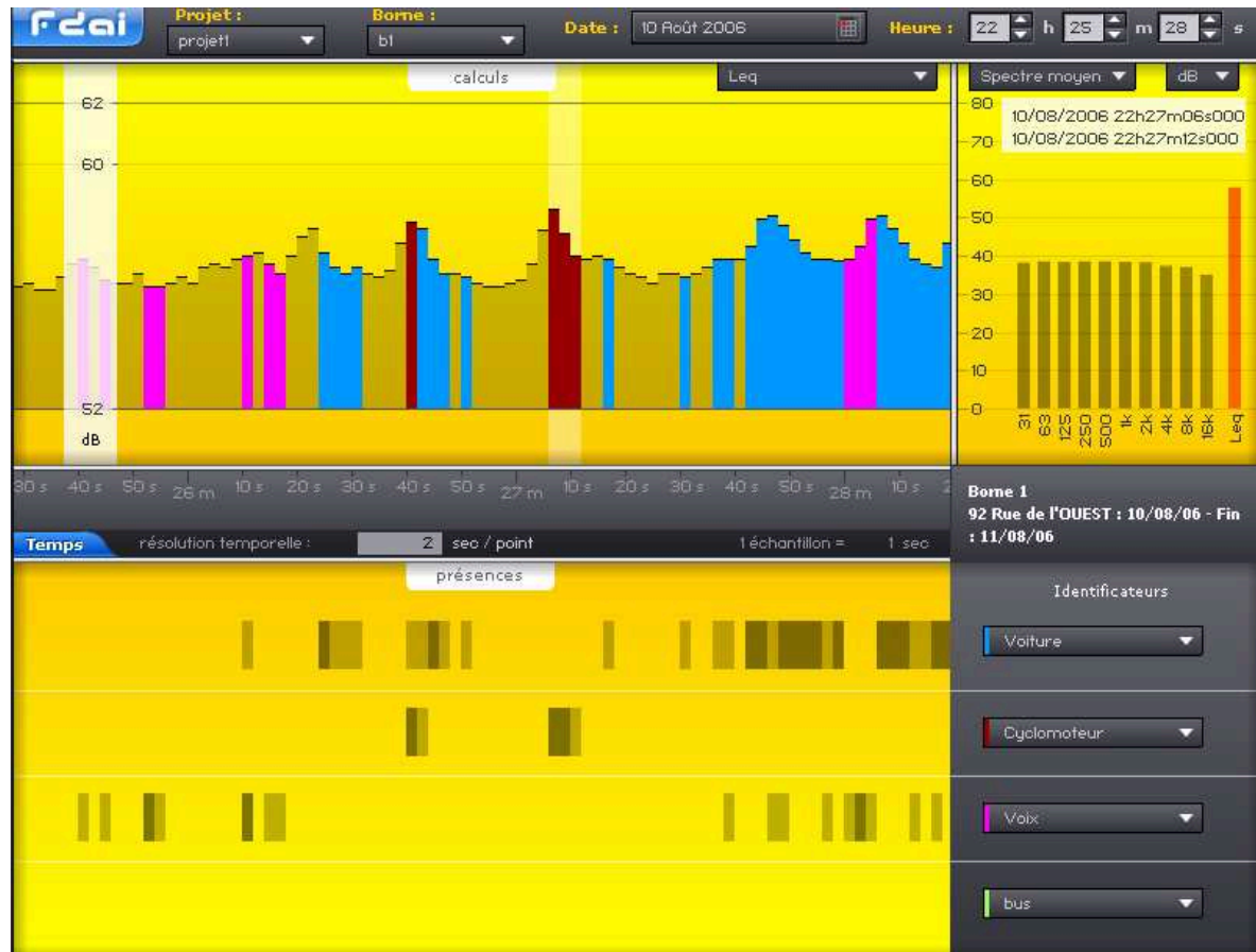
figure 73 : représentation temporelle des données mesurées/calculées à travers l'interface Web. Cette copie d'écran représente en haut l'évolution du LAeq mesuré en un point. Les couleurs sont les projections des sources identifiées mentionnées sur le cadre inférieur (voiture, Cyclomoteur, Voix, Bus). En haut à gauche, nous avons l'affichage des bandes d'octaves correspondant à une partie sélectionnée de la courbe du LAeq
