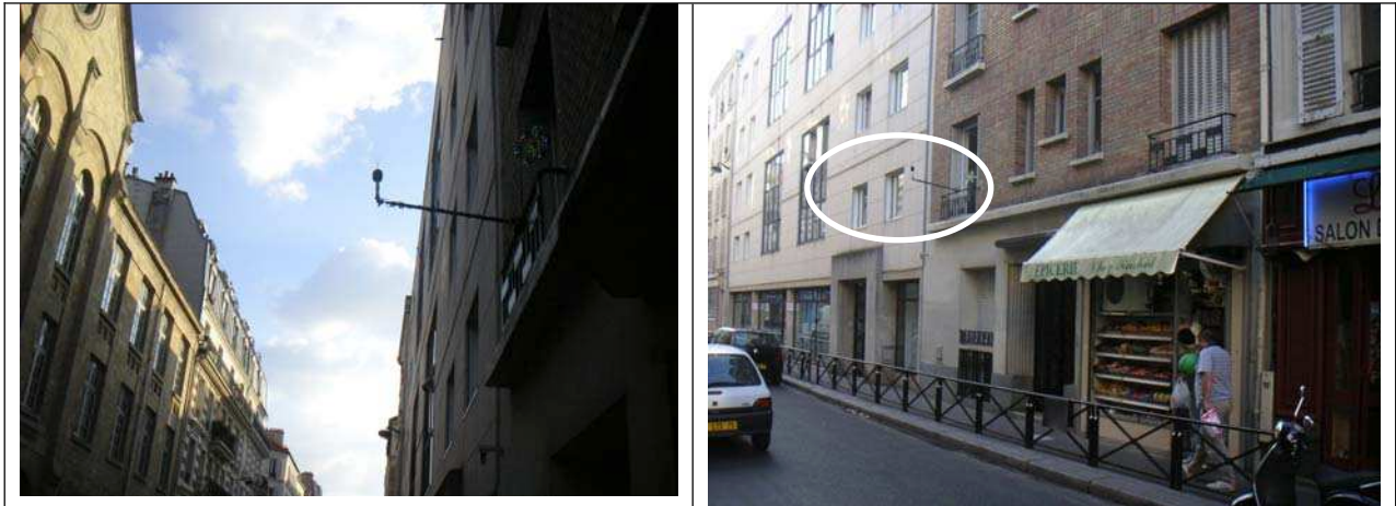
figure 71 : Le microphone est placé à deux mètres de la façade et à 4 mètres au dessus de la rue. Le microphone est connecté à un ordinateur qui calcule en temps réel des critères tels le L_{Aeq} et les bandes d'octaves mais également la détection de sources sonores.
