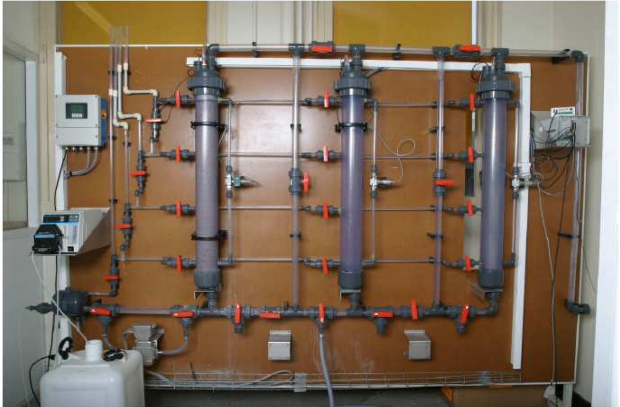
Figure 68. Dispositif expérimental, thèse de G. Benosman (ECP) : colonne de sol et banc gamma-densimétrique.
