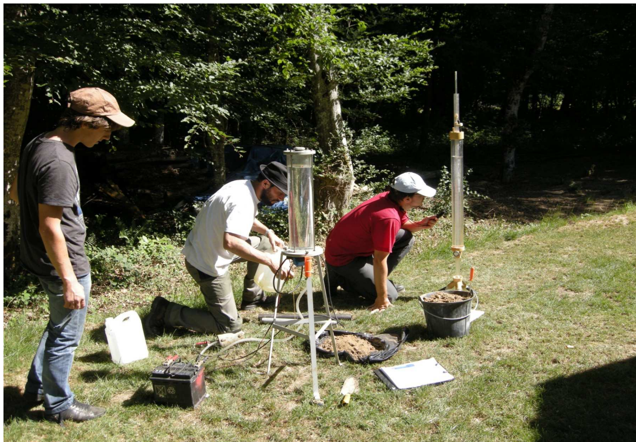
Figure 46. Tests des protocoles d'infiltration : au centre, l'essai Porchet, à droite l'essai Guelph.
