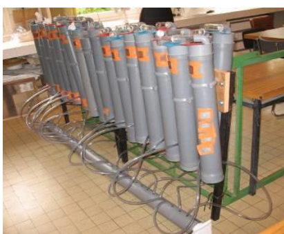
Figure 14. Cages d'émergence des parasitoïdes de puceron cendré. Un rameau infesté dont l'effectif de puceron est estimé par classe est introduit dans chaque tube en PVC qui constitue
