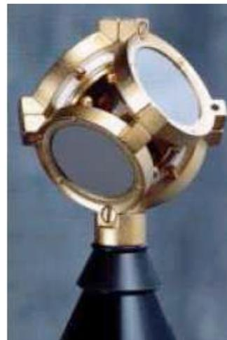
Figure B.7 : Les quatre capsules suivant les faces du tétraèdre et les trois directions (X, Y et Z)
