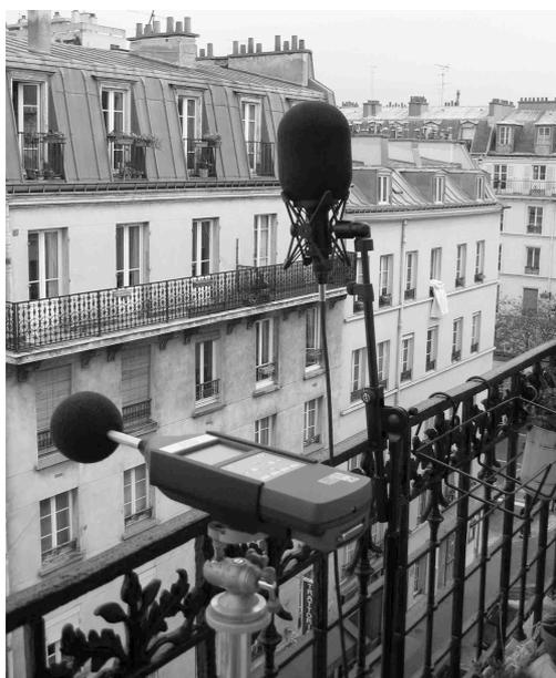
Figure B.10 Sonomètre (à gauche) et microphone Soundfield (à droite)
