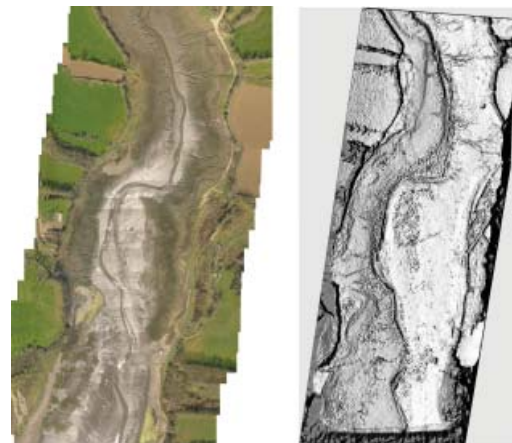
Figure 5. MNT calculé par l'ENSG à partir d'un jeu de photos collecté par le drone du LGCE/CETMEF le 30 mars 2012 (© G. Chapalain, R. Héno & M. Pierrot-Deseilligny).
