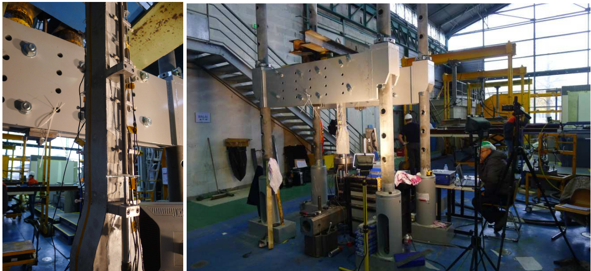
Figure 10 : Vue générale du montage d'essais et vue rapprochée de l'instrumentation par extensomètres extérieurs de la zone centrale des tirants
