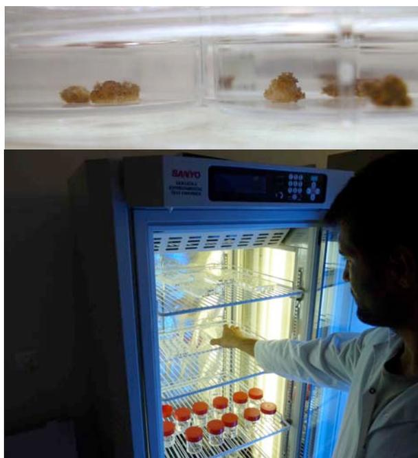
Figure 27 : (a) boutures dans les puits, (b) la chambre climatique SANYO utilisée pour la stabulation des essais. (photos ARVAM).
