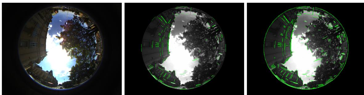
FIGURE 4 – Détection de segments par l'algorithme LSD (milieu) avec utilisation d'un redimensionnement de l'image (droite) sur une image acquise (gauche).
