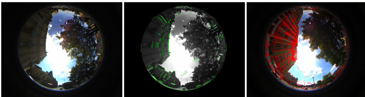
FIGURE 5 – Illustration d’une détection de segments (milieu), et de la création d’un maillage (droite) sur une image acquise en mobilité (gauche).
