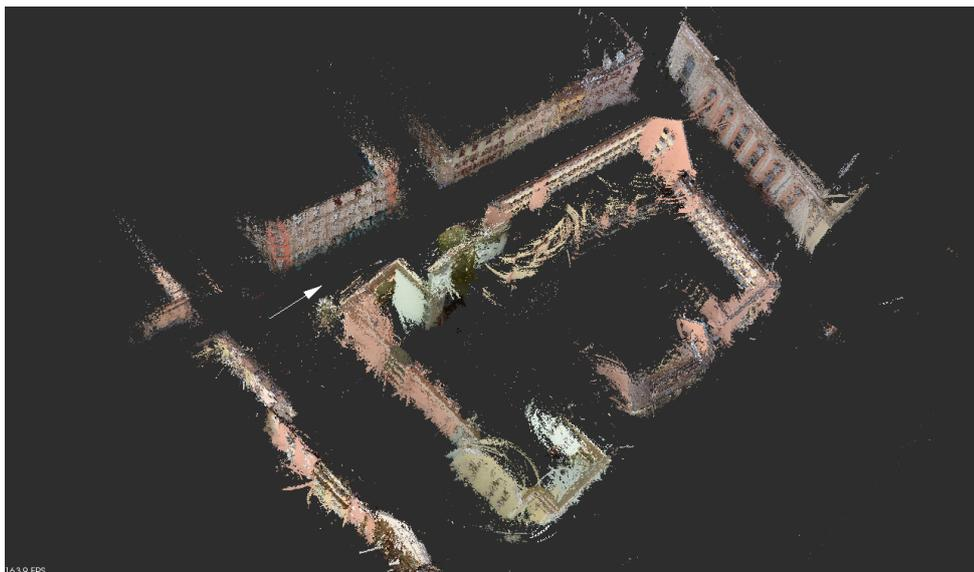
FIGURE 16 – Fusion des nuages de points obtenus le long d'une trajectoire complète.
