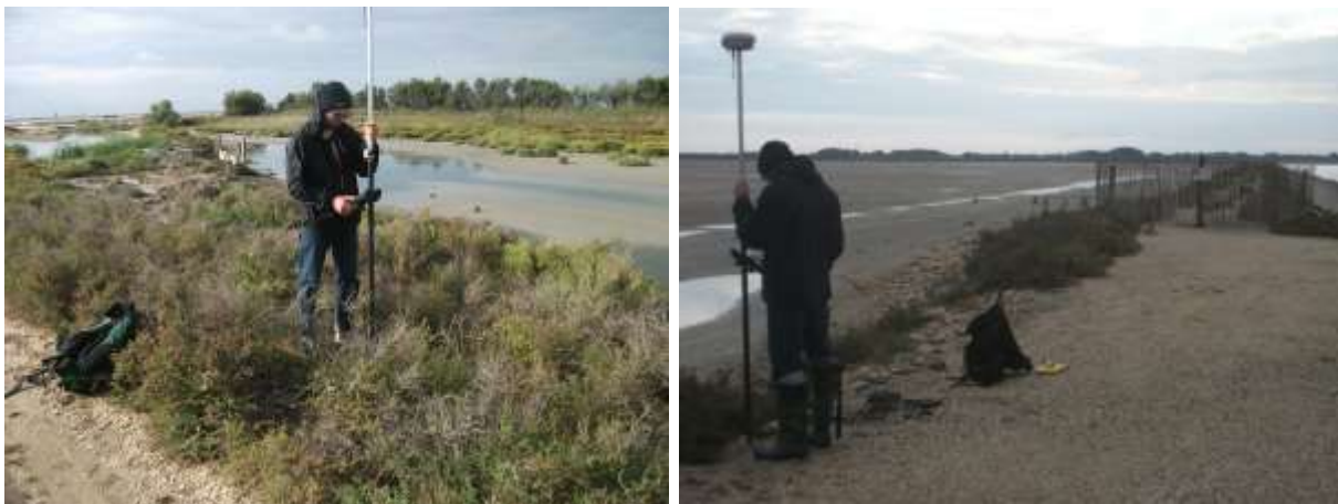
Figure 7 : Campagnes de mesure de la topo-bathymétrie, par GPS différentiel
