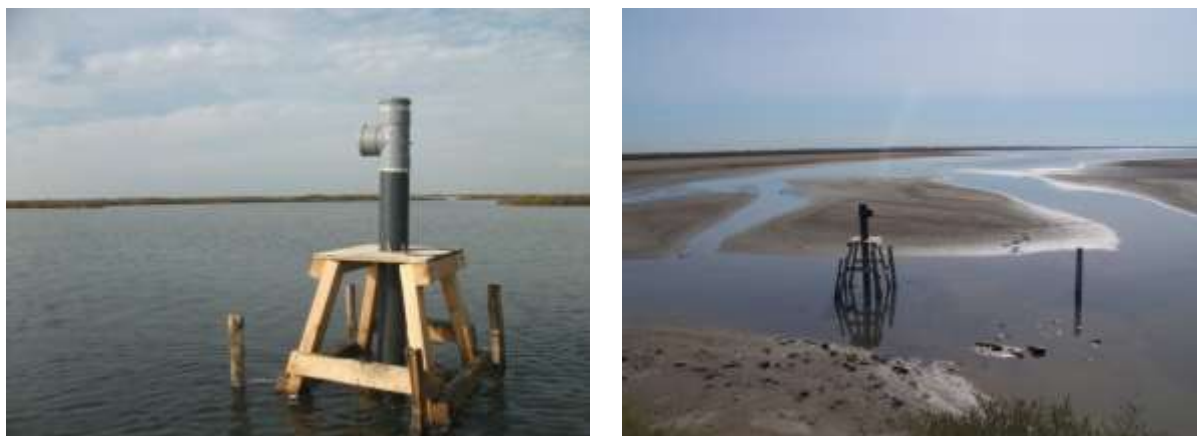
Figure 10 : Photographies des sondes de mesure en continu des niveaux d'eau
