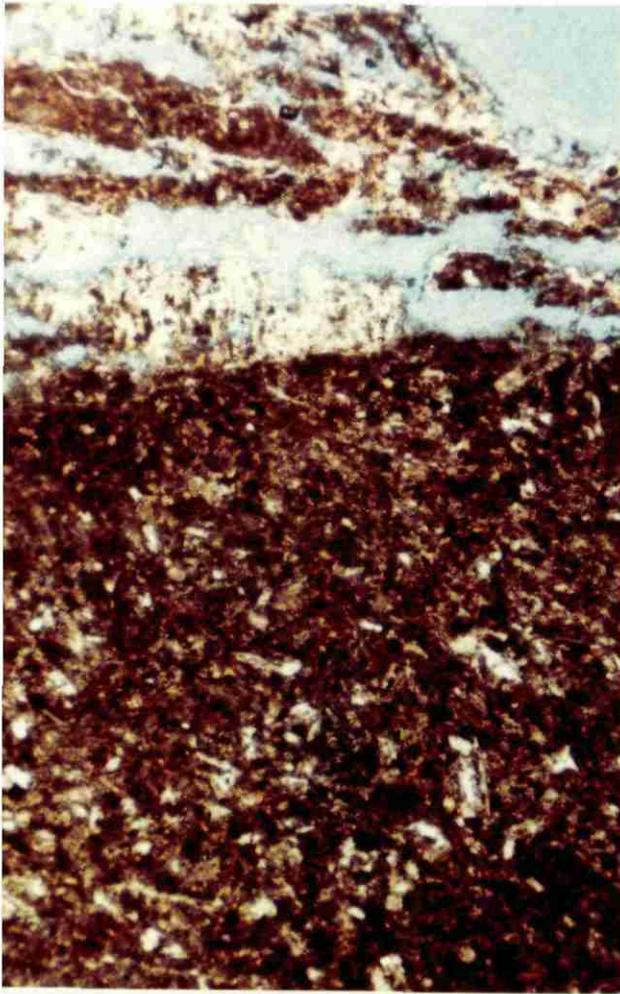
Zone externe fissures ouvertes à développement de gypse provoquant les boursouflures
