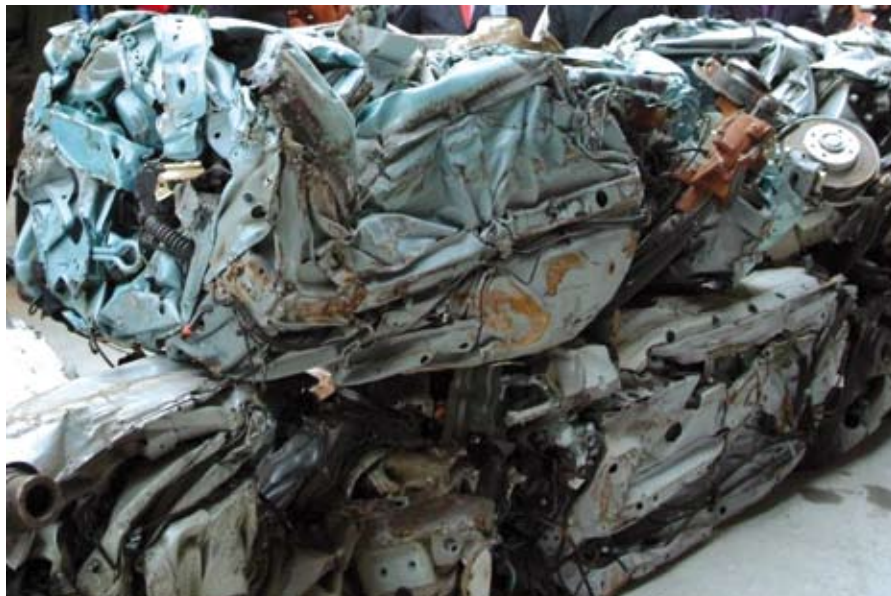
VHU après broyage par Menut : broyat de ferraille qui servira de matière première aux aciéries
