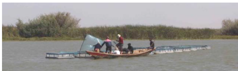
Figure 2. – Plateforme de 24 enceintes de 4 m 3 (1,5 x 1,5 x 2 m) installées in situ sur le réservoir de Dakar-Bango, plan d'eau d'alimentation en eau potable de Saint-Louis, deuxième ville du Sénégal. De gauche à droite, phases de remplissage et d'échantillonnage (Lazzaro X. © IRD).
