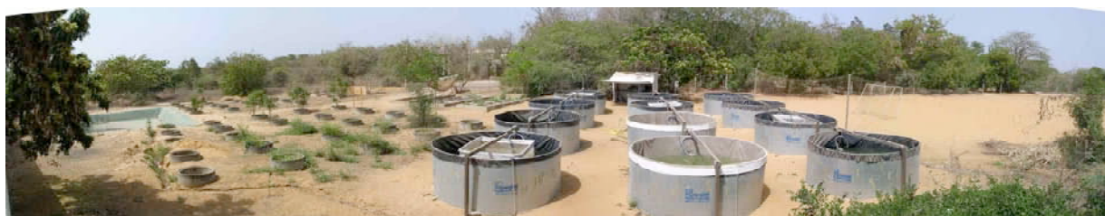
Figure 1. – Plateforme des mésocosmes de Bel-Air, Campus ISRA-IRD, Dakar, Sénégal, comprenant 12 bassins hors-sol de 10 m 3 (Ø 3,2 x 1,2 m) et un bassin de rétention de 105 m 3 (13 x 8 x 1 m). L'eau et le plancton sont acheminés par camion-citerne du réservoir de Dakar-Bango, 300 km au Nord-Est (Lazzaro X. © IRD).
