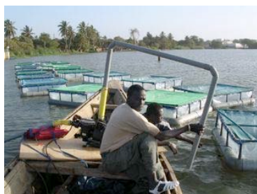
Figure 2. – Plateforme de 24 enceintes de 4 m 3 (1,5 x 1,5 x 2 m) installées in situ sur le réservoir de Dakar-Bango, plan d'eau d'alimentation en eau potable de Saint-Louis, deuxième ville du Sénégal. De gauche à droite, phases de remplissage et d'échantillonnage (Lazzaro X. © IRD).
