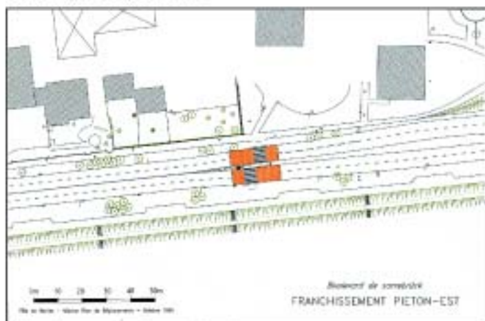
1. L'un des passages piétons et 2x2 voies
