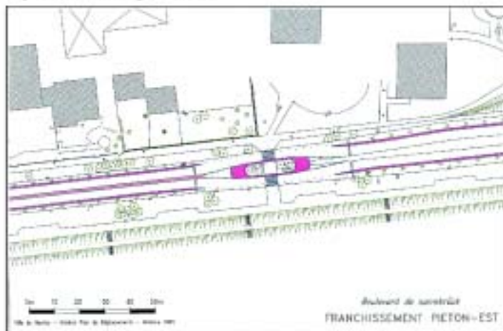
1. Le passage piéton réaménagé, 2x1 voies et pistes cyclables
