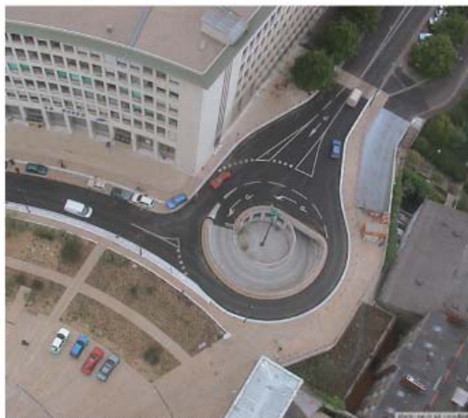
Faire coïncider entrée de parking et rond-point fait gagner en espace et en fluidité
