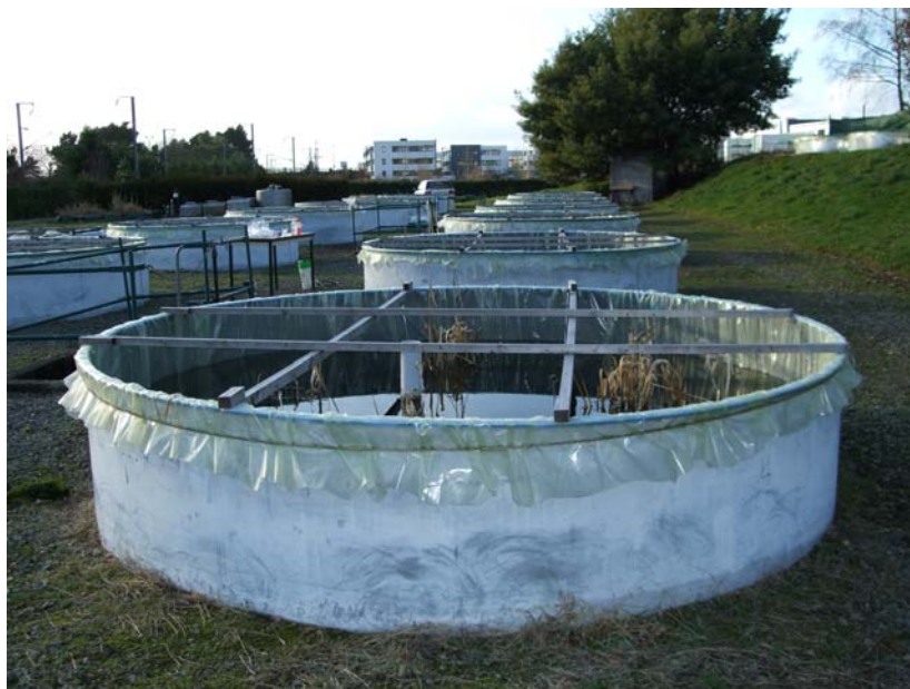
Figure 6. Mésocosmes lentiques de la plate-forme expérimentale de l'Unité Expérimentale Écologie et Écotoxicologie Aquatique de l'INRA de Rennes (U3E ; cliché F. Lagadic).
