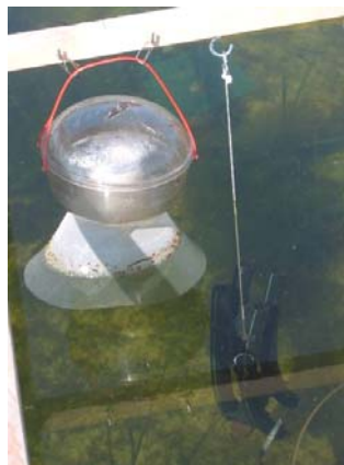
Figure 11. Piège à émergence (à gauche) et piège en tubes (à droite) pour l'échantillonnage des macro-invertébrés dans les mésocosmes lenticques.
