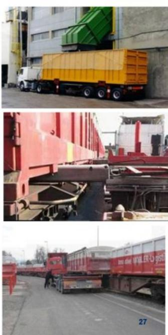
Il existe également des remorques auto-chargeuses permettant de transférer des conteneurs sur des wagons standards.
