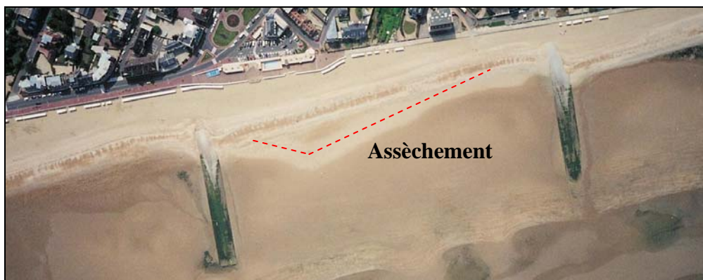
Figure 7 : photographie de la plage de Villers-sur-Mer réalisée lors d'un vol du drone, un an après l'implantation du procédé de drainage (M2C, juin 2004)
