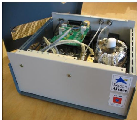
FIGURE 3: Source portable de formaldéhyde gazeux : 30,5 × 28 × 13,5 cm, ~4 Kg.
