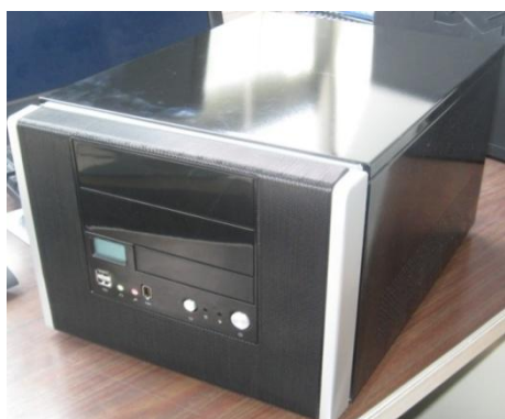
FIGURE 34: Prototype de 2 nd e génération de l'analyseur. Le prototype est transportable (env. 8 kg) et a une dimension de 28,5 x 23 x 38 cm.
