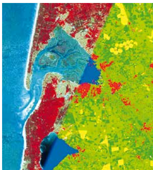
Figure 1 : Classification automatique en 7 classes (voir partie droite) à partir d'une image SPOT 5 - 10 mètre (partie gauche) - Baie d'Arcachon
