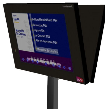
Figure 31 : Exemple d'affichage SNCF combinant la composition du train, le numéro, les destinations, l'heure de départ et le retard éventuel
