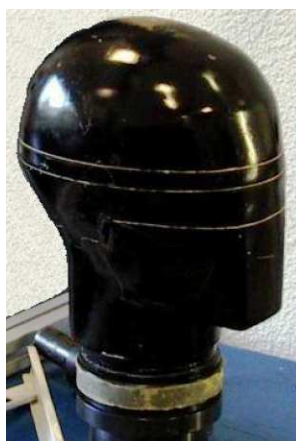
Figure 4-16. Exemple de fausse tête utilisée lors des tests normatifs expérimentaux dans la norme ECE 22 05.
