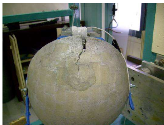
Figure 4-37. Dispositif expérimental et casque en mousse d'aluminium impacté.
